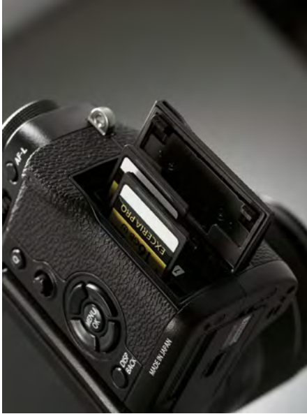
Рис. 7. Ваша камера X-T2 может одновременно работать с двумя SD-картами. Для достижения максимальной производительности вы должны использовать сверхскоростные карты стандарта UHS-II (такие как Lexar Professional 2000x – с номинальной скоростью до 300 Мб/сек)
